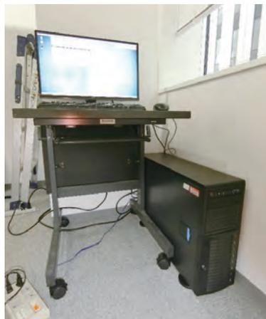
数値計算用の高性能コンピュータ。大き目のデスクトップコンピュータのようですが、Xeon-Dual CPUの44 Coreマシンです。数値シミュレーション用として大学院生が並列計算に使っています。
